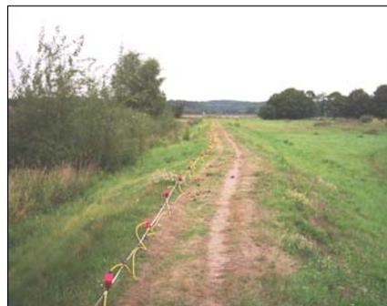
**Bild 2:** Geophysikalische Messungen (Geoelektrik)
